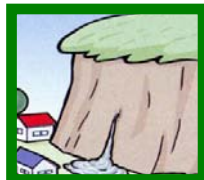
◆がけから水が湧き出ている
