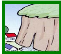
◆がけから水が湧き出ている
